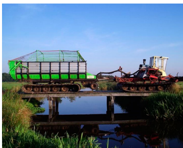
Billede 10. Maskinsæt til bjærgning af grøn biomasse på blødbundsareal.
