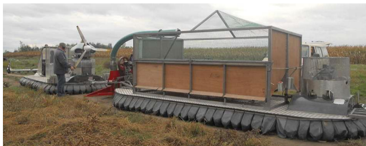
Billede 12. Luftpudebårne maskiner til biomassehøst. Forreste enhed (tv.) er redskabsbærer med skårlæggeraggregat, og bagerste enhed (th.) opsamler biomassen. Kilde: Ref. 1.
