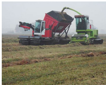
Billede 8. Opsamling og snitning af biomasse fra blødbundsareal med bælteudrustet finsnitner.
