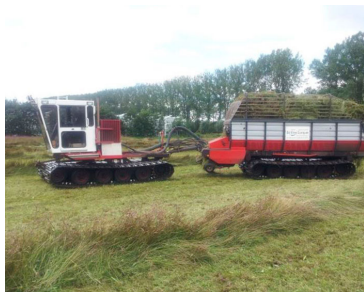
Billede 7. Opsamling af biomasse på blødbundsareal med specialbygget opsamlervogn.
